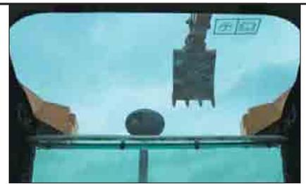
**Finestrini.** Per massimizzare la visibilità, tutti i vetri sono direttamente incollati sulla struttura della cabina, per ridurre al minimo i telai. E' disponibile un parabrezza fisso o apribile.
