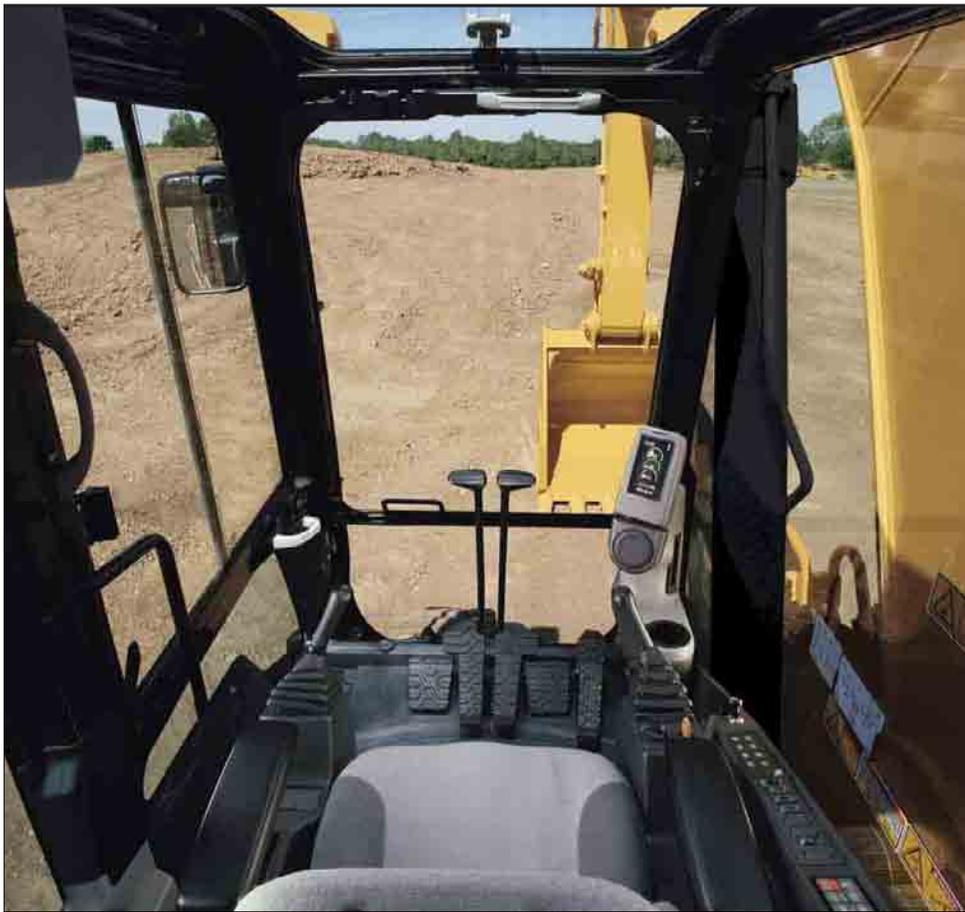
**Cabina.** La cabina, spaziosa e confortevole, assicura il massimo comfort e la massima produttività. I comandi del climatizzatore automatico e delle attrezzature sono convenientemente posizionati sul lato sinistro, mentre la chiave d'avviamento e l'acceleratore sono sul lato destro. Il monitor è ben visibile e di facile lettura.
