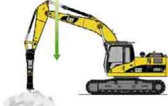
**Applicazioni con martello.** in quanto il braccio segue automaticamente il martello mentre questo avanza nella roccia. I colpi a vuoto o l'eccessivo carico sul martello sono evitati, assicurando così una maggiore durata a martello e macchina. Vantaggi simili si ottengono in caso di uso di piastre compattatrici.
