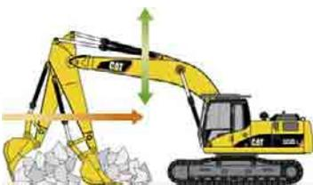
**Finitura.** In operazioni di finitura o pulizia del piano, rende il lavoro più facile e veloce. Lo SmartBoom consente il movimento flottante del braccio base e riduce l'impegno dell'operazione.
